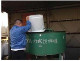
大型攪拌機に材料を投入
