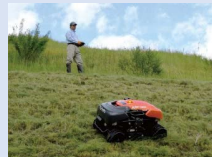
無線草刈機の運用に対応した傾斜
